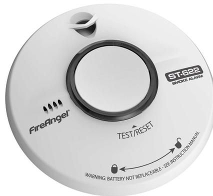
Votre détecteur de fumée doit être testé au moins une fois par semaine : appuyez sur le bouton de test au centre du détecteur et relâchez-le, puis l'appareil émet une alarme sonore puissante composée de 2 cycles de 3 bips sonores, puis s'arrête automatiquement (pendant cette alarme sonore, le voyant rouge sur le détecteur clignote rapidement)
